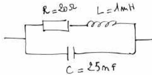
1) fréquence propre  $f_0 = \frac{1}{2\pi\sqrt{LC}} = \underline{31,8\text{kHz}}$
